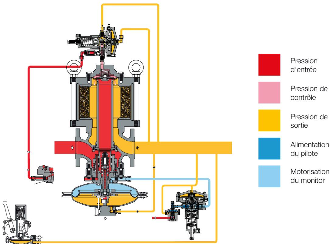
Figure 6 Terval/A avec silencieux DB
