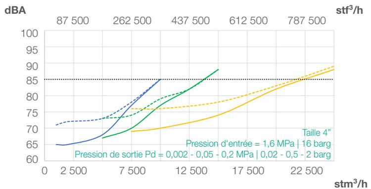
**Schéma 1** Schémas d'efficacité du silencieux du Terval/A
