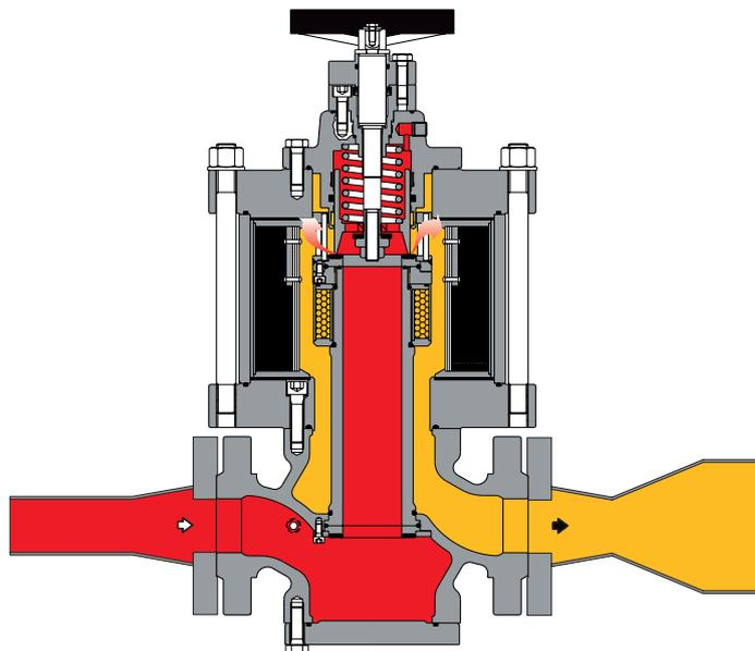
**Abbildung 5** VLM mit Schalldämpfer DB/819
