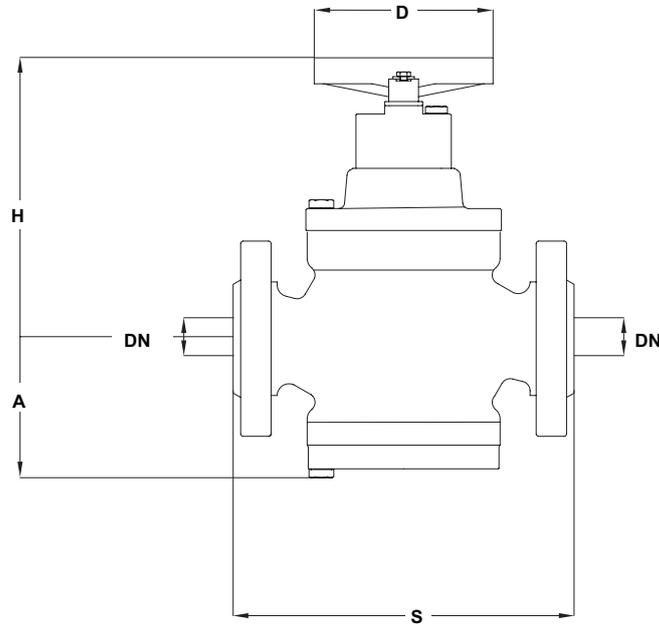
Abbildung 7 VLM - Abmessungen
