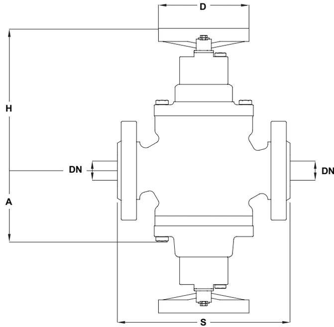
Abbildung 9 VLM + PM - Abmessungen
