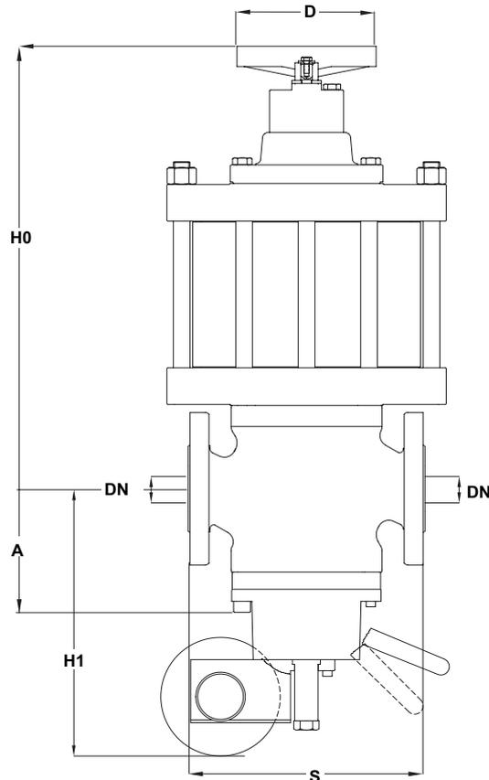
**Abbildung 12** VLM + DB/819 + SB/82 - Abmessungen
