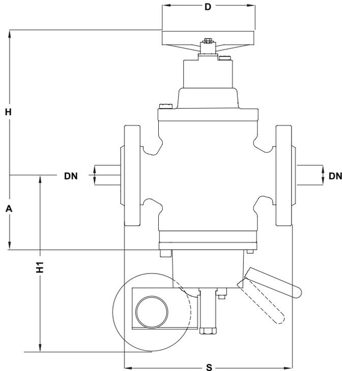
Abbildung 11 VLM + SB/82 - Abmessungen
